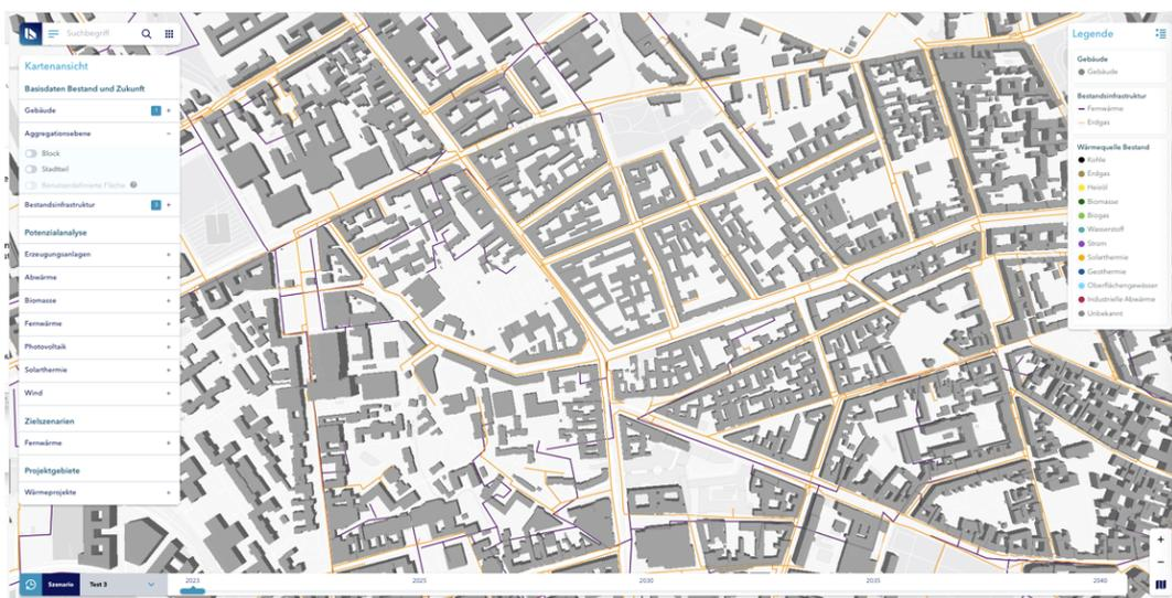
Abbildung 2: Darstellung der Bestandsinfrastruktur zu Gas und Fernwärme
