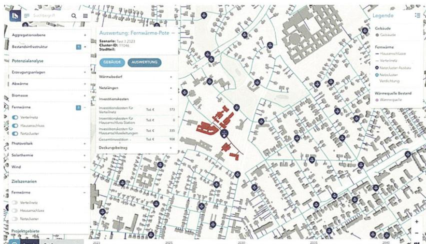
Bild 1. Fernwärmepotenziale werden über synthetische Netz-Cluster ausgewertet, Investitionskosten und Deckungsbeiträge werden errechnet
